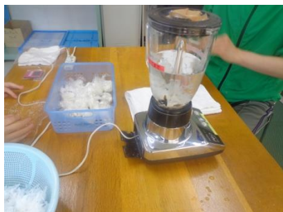
【作業①】牛乳パックから取り出したパルプをミキサーにかけるところ
