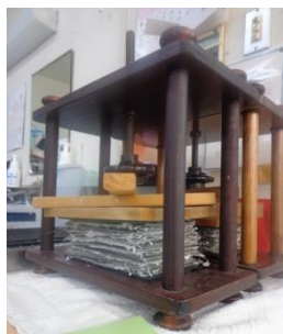
【作業②】パルプから紙を漉いた後に、水分を絞っているところ
